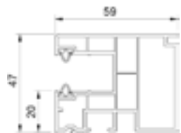
Prowadnica (PVC) jednostronna - RS rewizja od wewnątrz. MKM928(7)
